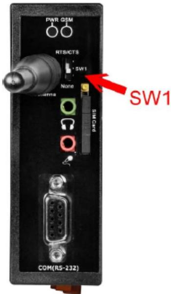
步驟 2. 控制台 → 網路連線 → 選擇您的 GPRS 名稱然後點選右鍵，並選擇內容 → 一般 → 選擇“標準 19200 bps 數據機” → 點選“設定” → 選擇“啓動硬體流量控制”
